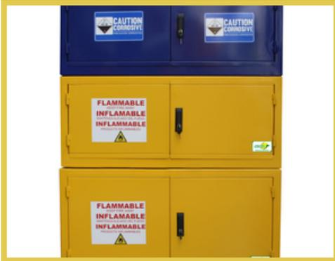
Cerrado con doble pared con separación de aislamiento de 1 1/2, fabricada en lamina cold rolled cal 16 con dos entrepaños, dos bocas de ventilación, con recubrimiento en pintura electrostática entre 70 y 90 micas de espesor en color amarillo.
