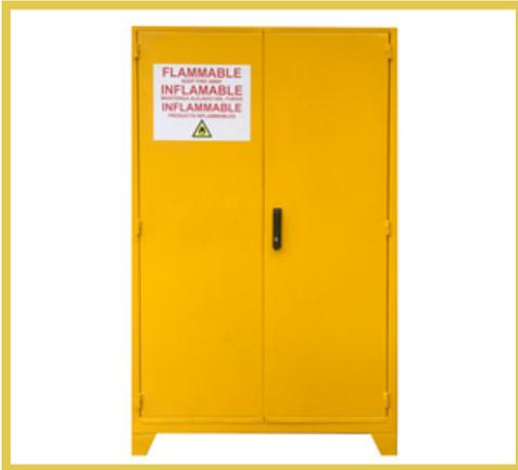
Cerrado con doble pared con separación de aislamiento de 1 1/2, fabricada en lamina cold rolled cal 16 con dos entrepaños, dos bocas de ventilación, con recubrimiento en pintura electrostática entre 70 y 90 micas de espesor en color amarillo.
