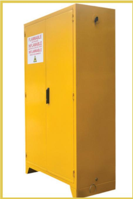
Cerrado con doble pared con separación de aislamiento de 1 1/2, fabricada en lamina cold rolled cal 16 con dos entrepaños, dos bocas de ventilación, con recubrimiento en pintura electrostática entre 70 y 90 micras de espesor en color amarillo.
