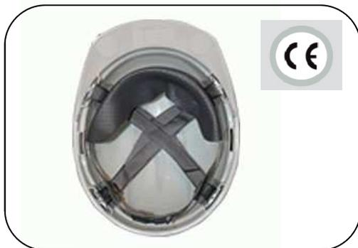
Fabricado en Polietileno alta densidad, diseño ultraliviano que brinda seguridad y comodidad, los cascos cuentan con un tafilete o suspensión liviana de nylon junto con un sistema de correa para su ajuste seguro. Diseñado para impactos verticales (Tipo I) y dieléctricos >20.000V (Clase E)
